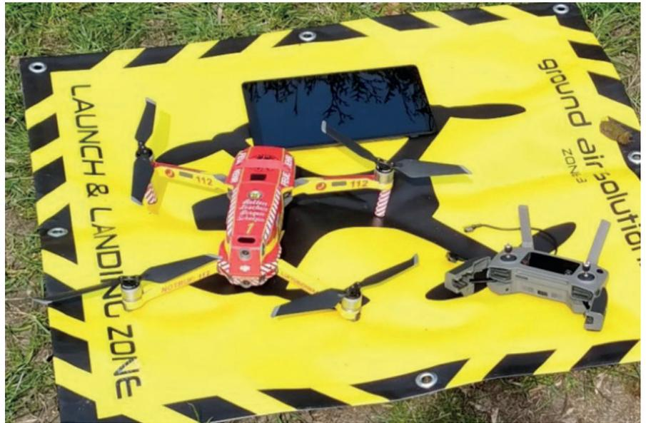
Bild (Breitschuh): Drohne vom Typ DJI Mavic 2 mit Fernsteuerung.
